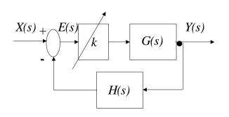
$$G(s) H(s) = \frac{k\left(s + \frac{1}{T_2}\right)}{s\left(s - \frac{1}{T_1}\right)\left(s^2 + 2\zeta\omega_n s + \omega_n^2\right)}$$
